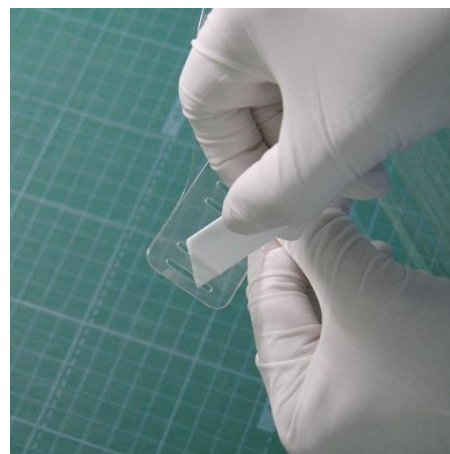
⑦ 反対側も同様、AB を重ねて、端から2つ目の穴に、内側から通す
